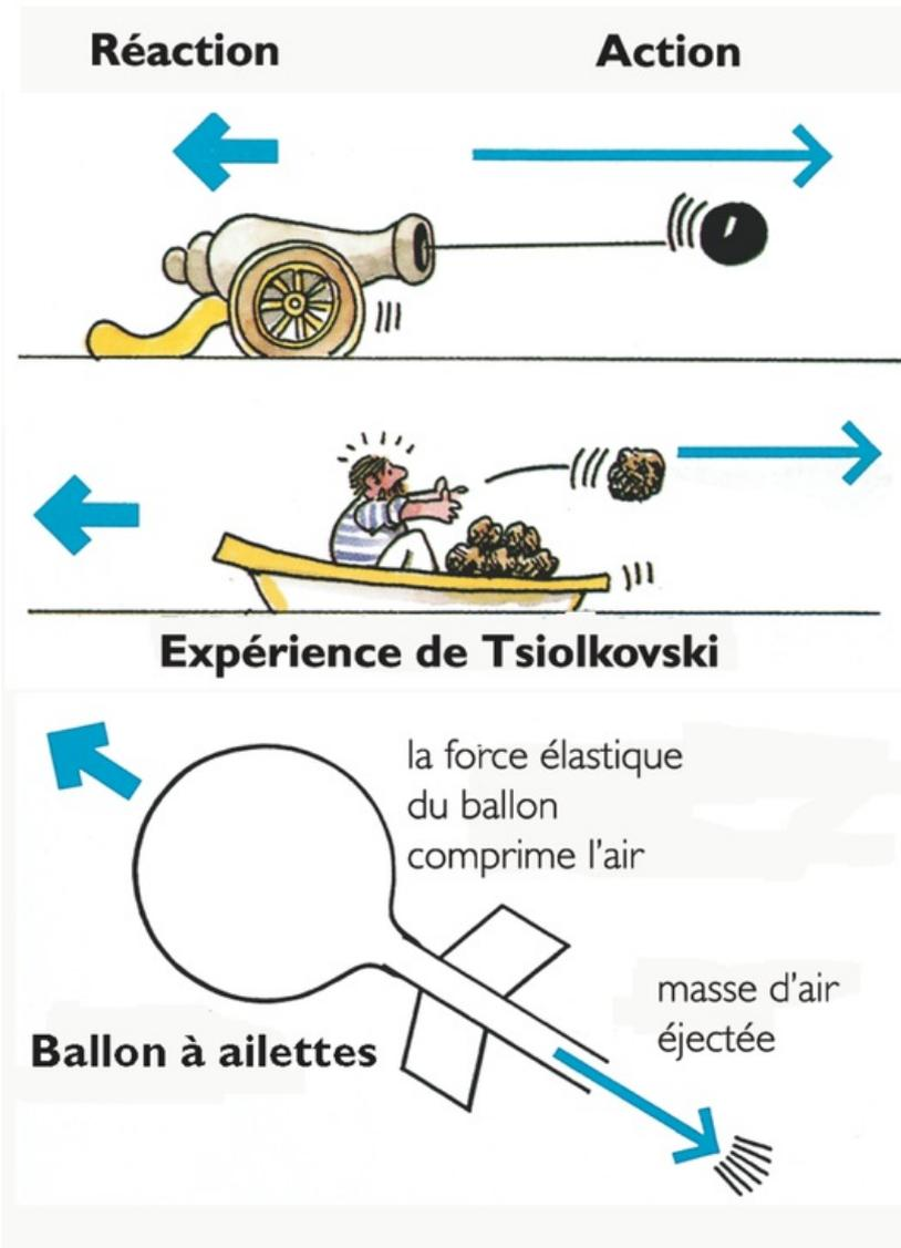
Dans ces trois situations, un objet (ou du gaz) est projeté vers la droite. En réaction, le système initial est propulsé vers la gauche. Le « recul » est d'autant plus fort que la masse éjectée est importante.
