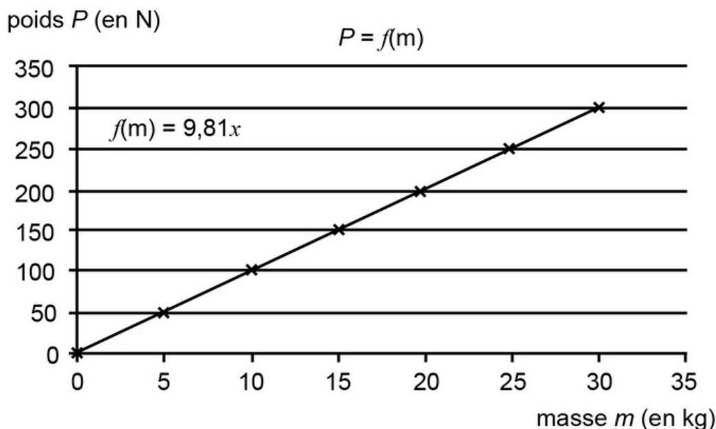
On constate que la fonction  $P = f(m)$  est **linéaire** puisque la droite passe par l'origine. Le coefficient directeur est ici 9,81 : la relation entre le poids et la masse est donc  $P = 9,81 \times m$ .
