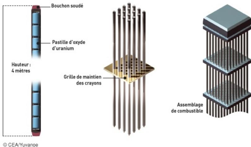
Après enrichissement, l'hexafluorure d'uranium est converti en oxyde d'uranium sous la forme d'une poudre noire. Celle-ci est comprimée puis frittée (cuite au four) de façon à former de petits cylindres d'environ 1 cm de long, appelés pastilles. Chaque pastille, qui ne pèse que 7 g, peut libérer autant d'énergie qu'une tonne de charbon.
