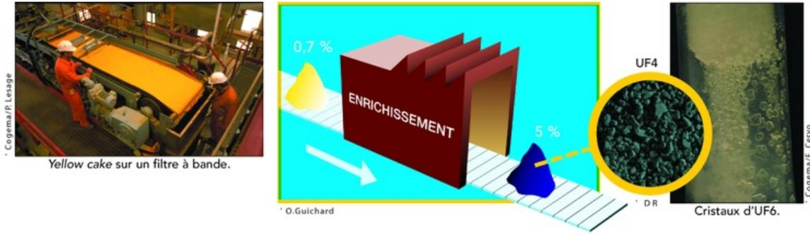
Le « yellow caked », issu de la dissolution du minerai d'uranium, est converti en tétrafluorure puis en hexafluorure d'uranium gazeux. La plupart des réacteurs nucléaires en service dans le monde fonctionnent à partir de la fission d'uranium 235. Seulement, ce minerai ne représente que 0,7 % de la totalité de l'uranium naturel. Il faut donc enrichir en uranium 235 la matière première qui va servir à fabriquer le combustible.
