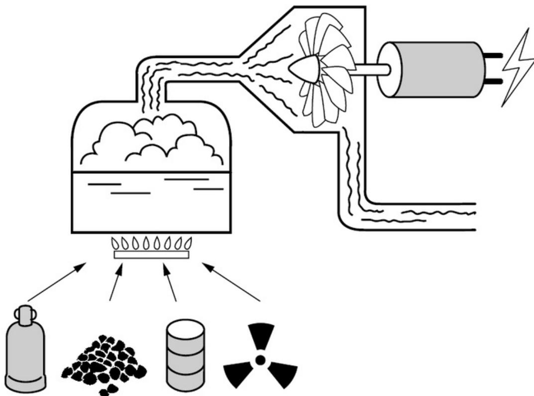
Une **centrale thermique** utilise des **combustibles** (gaz, charbon, pétrole ou uranium) pour chauffer de l'eau. La pression de la vapeur d'eau obtenue fait tourner les turbines.
