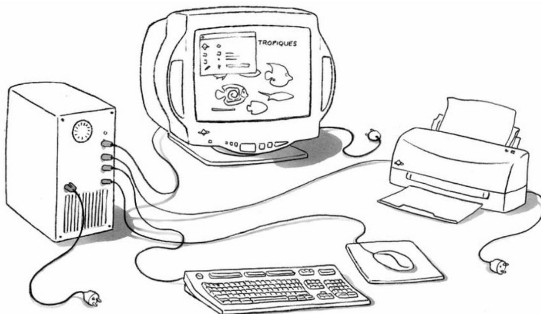
Pour fonctionner, l'unité centrale, l'imprimante et l'écran d'un ordinateur doivent être reliés à une **prise de courant**.
