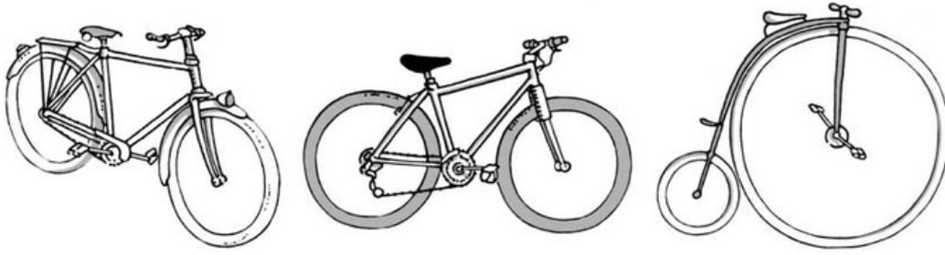
Le premier vélo fut inventé en 1813, il s'agissait d'une machine à deux roues propulsée par les pieds exerçant alternativement une poussée sur le sol. Des pédales furent ajoutées en 1861, et le diamètre de la roue avant fut agrandi : ce fut l'apparition du **grand bi**.
