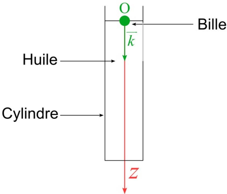
Figure 1. Schéma du dispositif expérimental de mesure
