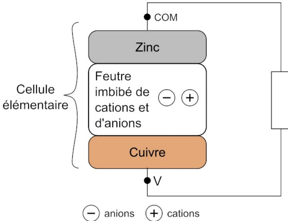
La question précédente permet de déterminer la cathode. Les électrons vont du pôle - vers le pôle +.
