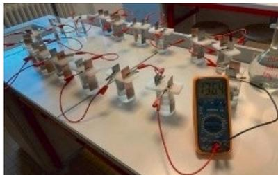
On souhaite étudier l'évolution de la tension électrique délivrée par l'ensemble des cellules en fonction du nombre de cellules constituant le système. Ainsi, on réalise plusieurs mesures de tension  $U$  aux bornes d'un ensemble de  $N$  cellules, associées en série, en modifiant le nombre  $N$  de cellules. Les résultats sont donnés sur la figure 4.
