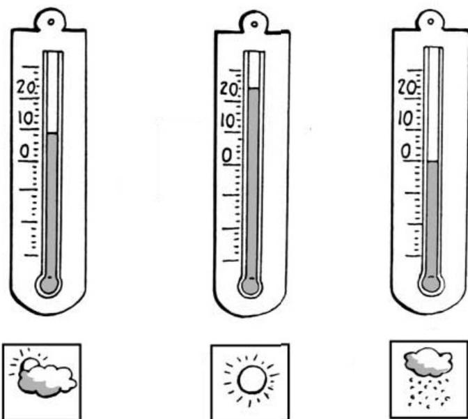
Pour mesurer la température, on utilise un **thermomètre**. Cet instrument, le plus souvent **gradué en degrés**, contient un liquide qui « monte » et « descend » selon la température : il suffit alors de repérer la graduation sur laquelle il s'est arrêté.
