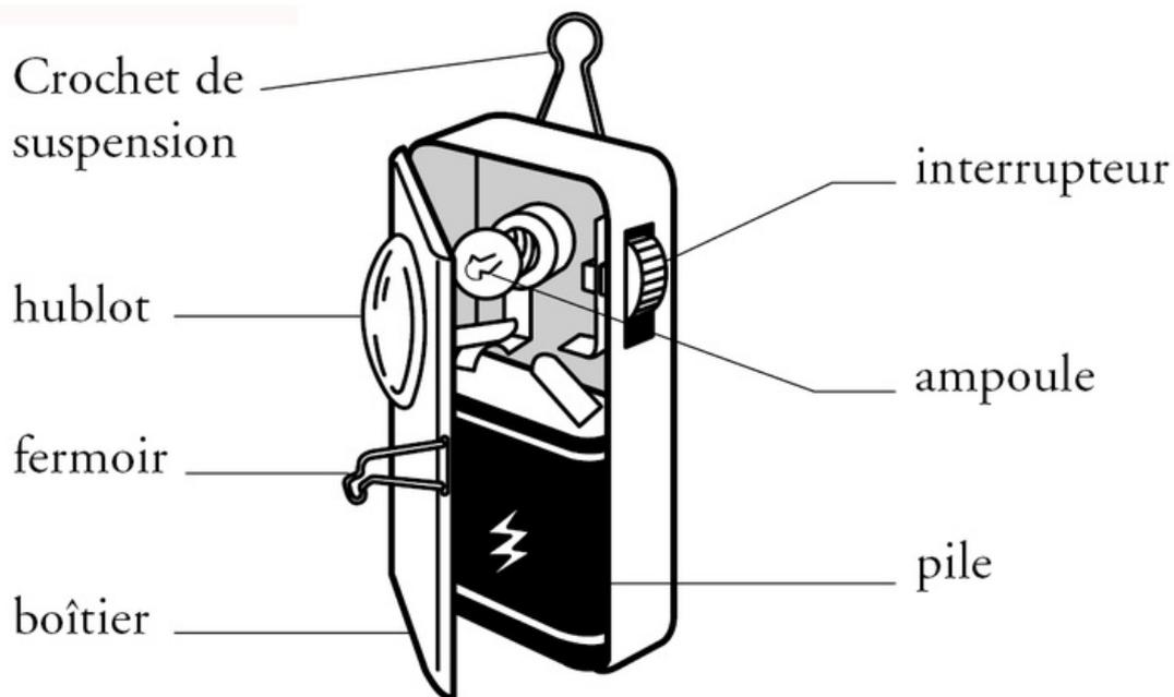
Le **boîtier** protège le **circuit électrique** et permet une bonne préhension. Le **fermoir** permet l'ouverture et la fermeture du boîtier. L'**ampoule** éclaire. L'**interrupteur** sert à allumer et éteindre la lampe. La **pile** fournit l'énergie nécessaire. Le **crochet** est prévu pour accrocher la lampe, tandis que le **hublot** améliore l'éclairage.
