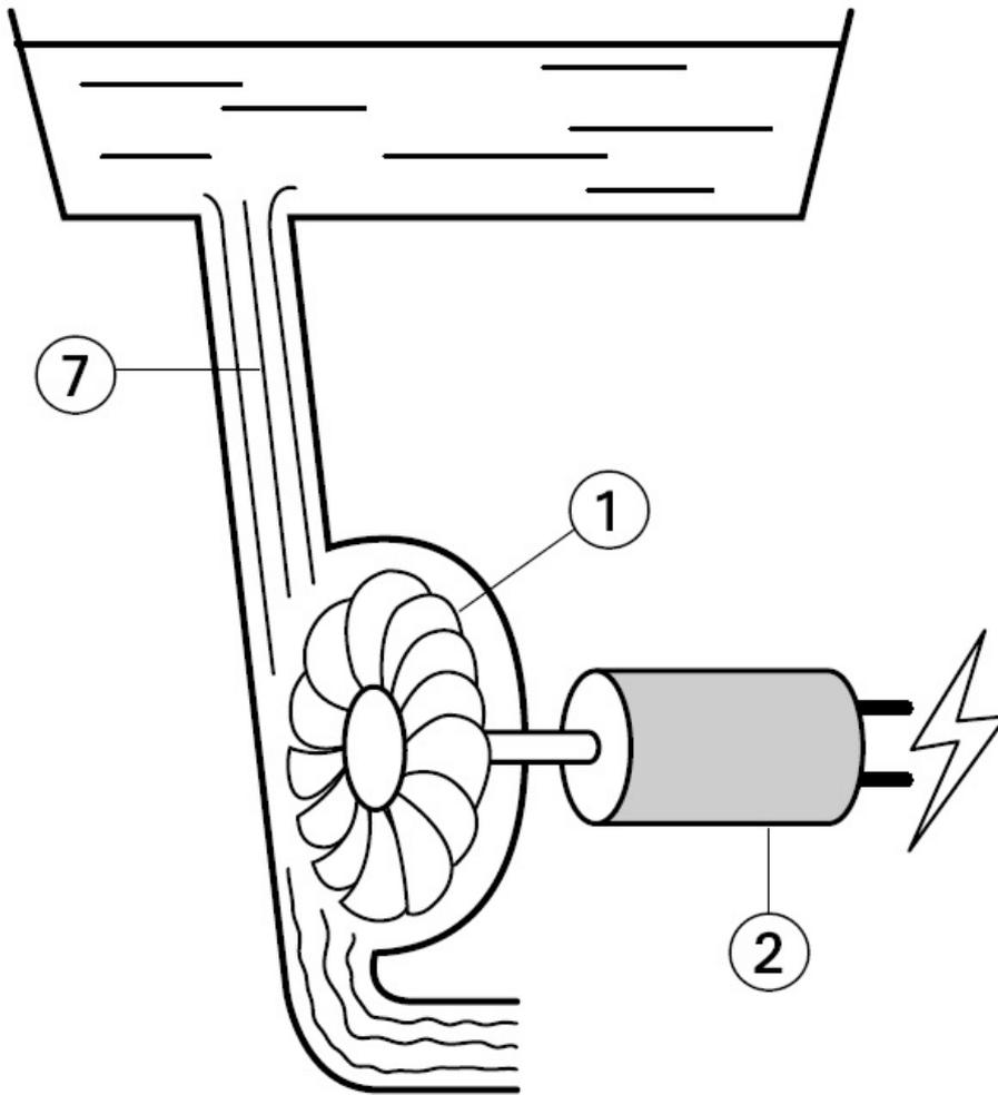
Une **centrale hydraulique** utilise la **force de l'eau** (courant, chute ou marée) pour faire tourner les turbines.
