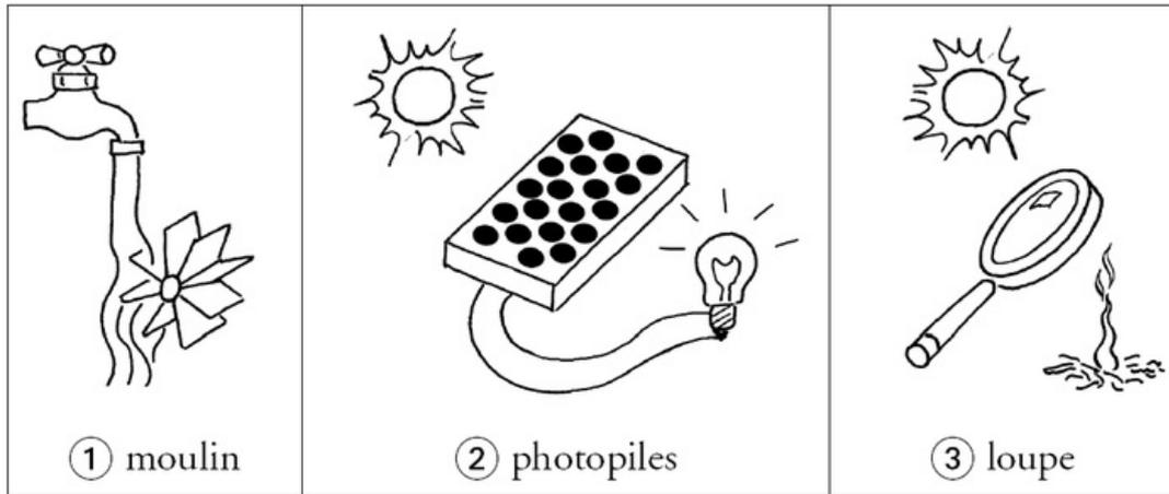
Expérience 1 : l'énergie de départ est **mécanique** ; grâce au dispositif du moulin à eau, on obtient une énergie également mécanique, l'intérêt étant de transformer un mouvement de poussée en mouvement rotatif.
