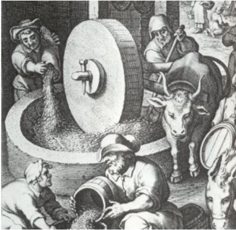
Les olives sont d'abord trempées dans l'eau froide, puis elles sont écrasées et la pâte obtenue est pressée à froid pour en extraire un mélange d'huile et d'eau (les margines).
