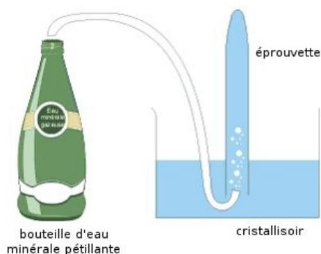
**Le gaz présent dans la bouteille d'eau s'échappe pour aller dans l'éprouvette**
