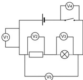
• *Mesure :*  $U_1 = 0,002 \text{ V}$  ;  $U_2 = 2,95 \text{ V}$  ;  $U_3 = 1,51 \text{ V}$  et  $U_4 = 0,003 \text{ V}$  (quand l'interrupteur est fermé).
