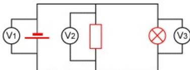
• *Mesure :*  $U_1 = 4,48 \text{ V}$  ;  $U_2 = 4,47 \text{ V}$  et  $U_3 = 4,48 \text{ V}$ .
