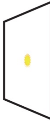
Un point lumineux est observé sur l'écran, au foyer de la lentille
