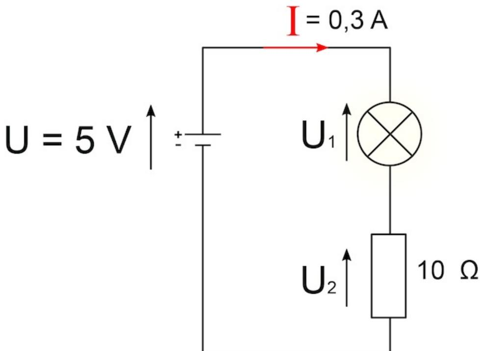
$I = 0,3 \text{ A}$  et  $R_l = 10 \Omega$ . Donc d'après la loi d'Ohm :  $U_2 = 3 \text{ V}$ .
