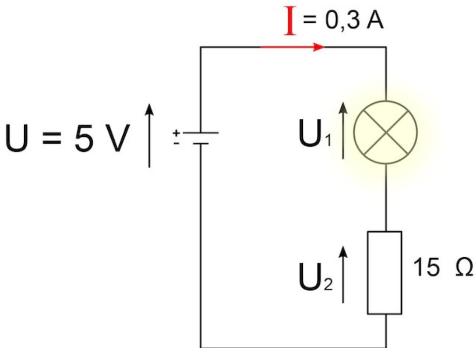
$I = 0,3\text{ A}$  et  $R_2 = 15\ \Omega$ . Donc d'après la loi d'Ohm :  $U_2 = 4,5\text{ V}$ .
