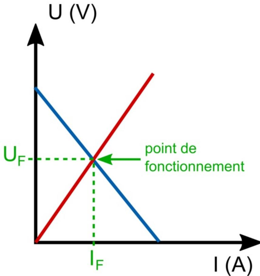
Le point de fonctionnement du circuit ainsi constitué est le couple de valeur  $(U_F ; I_F)$  que l'on détermine graphiquement.
