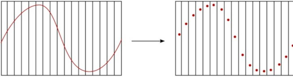
Schéma d'un échantillonnage à une fréquence  $f_2 > f_1$
