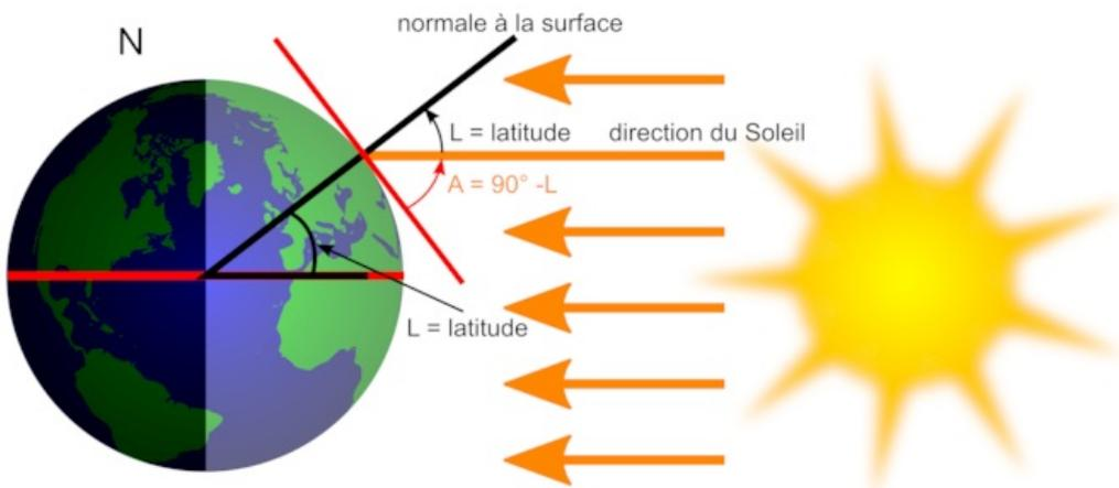
Par exemple, à Bordeaux le Soleil aura une hauteur de  $H = 90 - 45 = 45^\circ$ . On peut également calculer la hauteur du Soleil à Oslo :  $H = 90 - 60 = 30^\circ$ . Au pôle Nord géographique  $H = 0^\circ$ , le Soleil n'apparaîtra quasiment pas.
